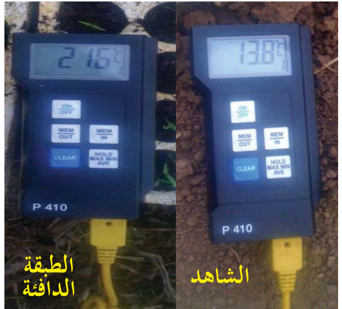
صورة رقم 3: قياس درجة الحرارة تحت الأطباق (plaque alvéolée)
